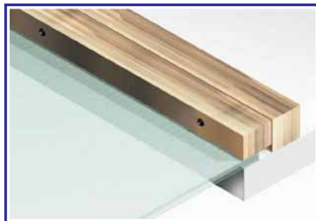
DETAILNÝ POHLAD UPEVNENIA S DVOJITOU LIŠTOU Z DREVA
