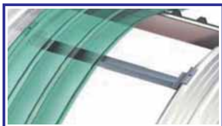
DETAIL NAPOJENIA STREDOVÉHO OBLÚKOVÉHO PANELU V DĹŽKE
