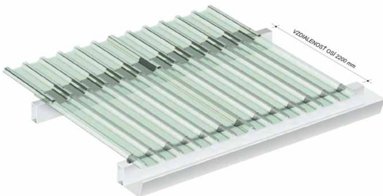
DETAILNÝ POHĽAD UPEVNENIA A BOČNÉHO NAPOJENIA MEDZI PRESVETLOVACÍMI PANEĽMI
